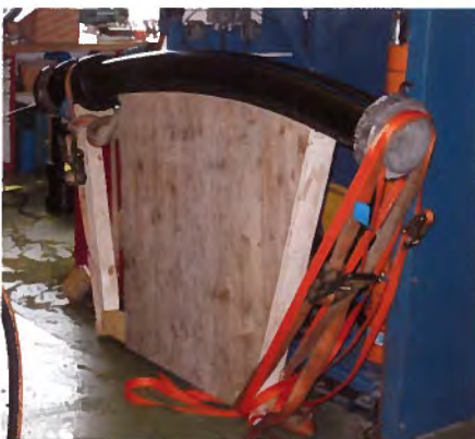
ROHR UND RUCK-ZUCK IN DN 150 ÜBER EINEN VORDEFINIERTEN BOGEN GESPANNT. DRUCK IM ROHR: 28,8 BAR DAUER: 60 MINUTEN ERGEBNIS: POSITIV
