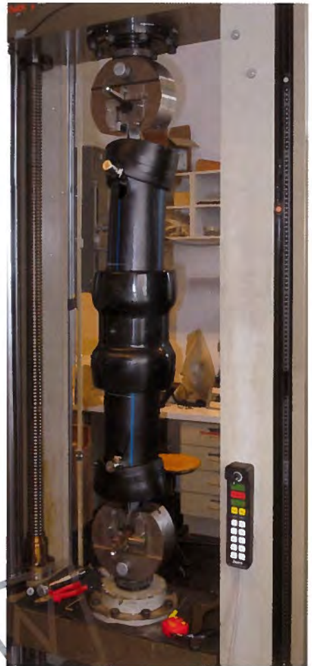
ROHR UND RUCK-ZUCK IN DN 150 IN ZUGMASCHINE EINGESPANNT. ZUGKRAFT: 7 TONNEN DAUER: 60 MINUTEN MASSIVE BESCHÄDIGUNGEN AN ROHR UND SPANNELEMENTEN ERGEBNIS: POSITIV
